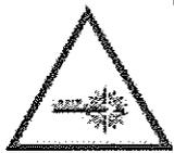
L'utilizzo dei laser comporta a seconda del tipo di sorgente usata, l'osservanza di alcune norme operative per garantire sicurezza a tutto il personale potenzialmente esposto. Le zone in cui sono in uso apparecchiature laser sono segnalate da cartelli indicanti il segnale di pericolo di emissione laser e la dicitura:
