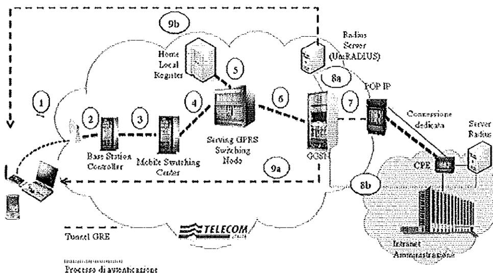
Si sottolinea inoltre che, mediante tale connessione dedicata, sarà possibile collegare la sede dell'Amministrazione alla piattaforma di messaggistica avanzata ed alla piattaforma di erogazione dei servizi Work Force Automation e Mobile Device Management (§§ 2.7, 2.7.1, 2.7.2, 4.9).
