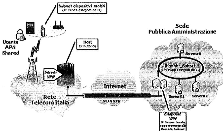
La VPN IPSEC (che garantisce la riservatezza dei dati attraverso la cifratura del canale di comunicazione) è realizzata utilizzando lo specifico client presenti su tutti i terminali Android presenti in Convenzione. Per i terminali dotati degli altri sistemi operativi è possibile comunque utilizzare Client VPN IPSEC di terze parti. Tale modalità di accesso è utilizzabile anche da computer portatili tramite uno dei modem in convenzione, insieme ad un qualsiasi client IPSEC (quest'ultimo non
