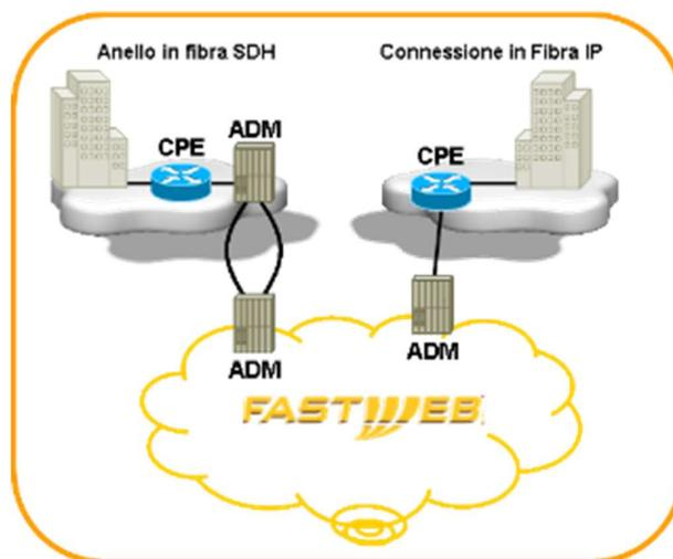
Per aumentare la disponibilità del collegamento in fibra è possibile portare un secondo collegamento in single-homing (da sede Amministrazione a medesimo PoP Fastweb mediante due coppie distinte e diversificate) oppure in dual-homing (da sede Amministrazione verso due PoP Fastweb distinti).
